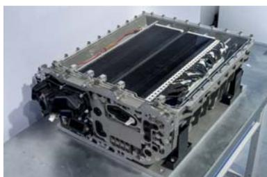
1 | Wasserstoff-Brennstoffzellenstapel
