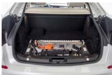
4 | Wasserstoff-Brennstoffzellen-Antrieb
