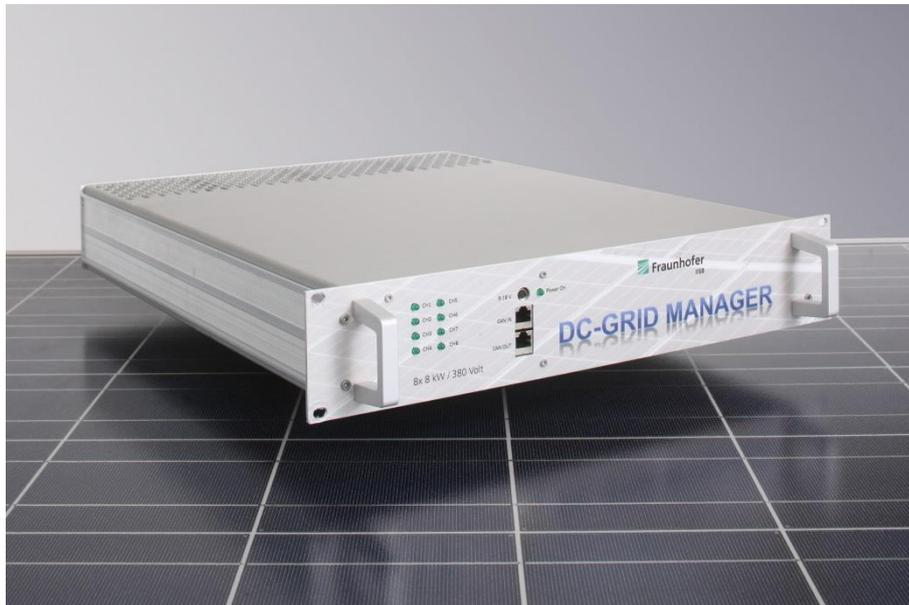
*DC-Grid Manager des Fraunhofer IISB, universelle Kernkomponente für lokale Gleichstromnetze.
