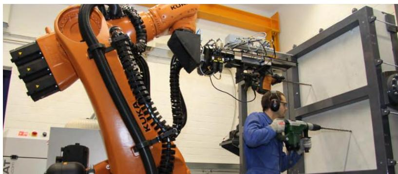
*Im Power-Tool-Prüffeld des KIT testen Roboter Elektrowerkzeuge automatisiert, wie es Menschen manuell tun würden. (Bild: KIT)*
