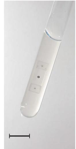
*Fünf-Millimeter-NMR-Röhrchen mit Lenz-Linse. Das Röhrchen ist mit dem Polysaccharid Agarose gefüllt, das sich herkömmlichen NMR-Systemen nicht detektieren ließe. (Abbildung: Nils Spengler/KIT)*
