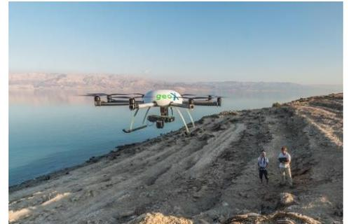
*Oktokopter liefern Luft- und Thermalbilder mit einer sehr guten räumlichen Auflösung. Die Forscher nutzen sie, um digitale Geländemodelle zu erstellen oder unterirdische Grundwasserzuflüsse zu identifizieren. (Foto: André Kuenzelmann, UFZ)*
