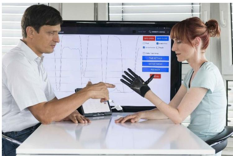
Ein Baukastensystem für künstliche Handprothesen mit Tastsinn der Firma Vincent Systems ermöglicht es die Technologie individuell auf den Träger anzupassen. Bild: Ansgar Pudenz / Deutscher Zukunftspreis
