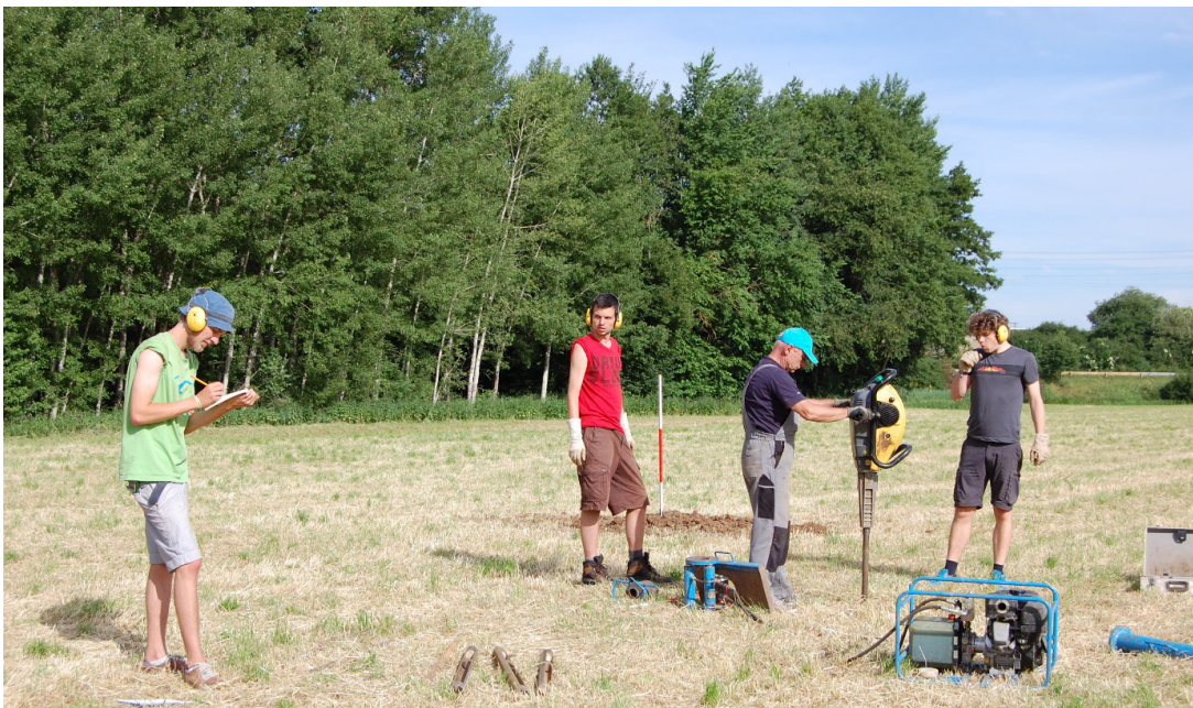
Mitarbeiter und Geographiestudenten der Universität Leipzig bei der Durchführung der geoarchäologischen Rammkernsondierungen am Karlsgraben (Fotoquelle: Arbeitsgruppe Physische Geographie, Universität Leipzig, André Kirchner)
