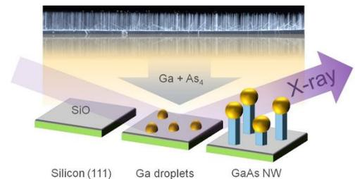
*Untersuchungsprinzip: Auf einem Siliziumträger wachsen durch den Beschuss von Gallium-Tröpfchen mit Gallium und Arsen kleine dünne Nanodrähte. Das Wachstum lässt sich mit Röntgenstrahlung (X-ray) live verfolgen. Abschließend wurden die Nanodrähte mit dem Elektronenmikroskop untersucht (Hintergrund). (Bild: Philipp Schroth, KIT)*
