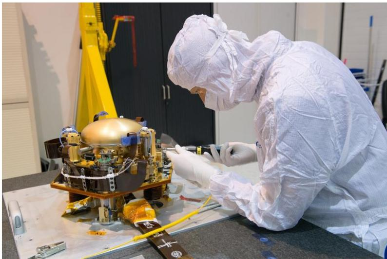
Tests in Schiltach: ein Seismometer-Paket, das dem entspricht, das bei der Mars-Mission „InSight-Lander“ ab Mai 2018 im Einsatz sein wird (Foto: Copyright CNES).
