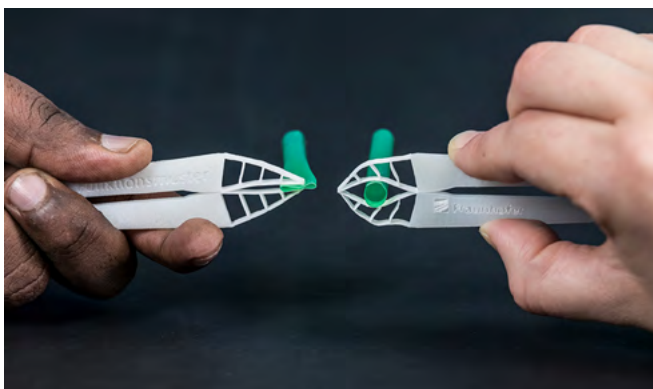
Funktionsmuster der formadaptiven Pinzette halten Strohhalm. Wie links im Bild zu sehen, kann mit der Spitze der Pinzette Kraft ausgeübt werden. Wie rechts im Bild zu sehen, können Objekte zwischen den Maulflächen der Pinzette gehalten werden, ohne größere Kräfte zu erfahren. (Quelle: Fraunhofer IPA, Foto: Rainer Bez)
