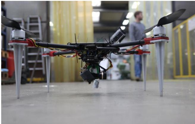
Zum Abflug bereit: Eine Drohne scannt mithilfe einer 3D-Kamera den gesamten Produktionsbereich.
