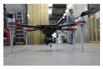
Zum Abflug bereit: Eine Drohne scannt mithilfe einer 3D-Kamera den gesamten Produktionsbereich. (Quelle: IPH)
