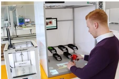
Intelligente Assistenzsysteme unterstützen den Werker interaktiv bei einem Montagevorgang und leiten ihn beispielsweise über Projektionen oder Datenbrillen durch die Arbeitsschritte. (Bildquelle: Fraunhofer IOSB-INA)
