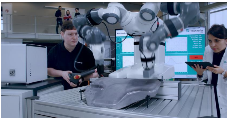
Die Wissenschaftlerin Dr. Yasmine Gabi und der Ingenieur Frank Leinenbach bei der Prüfung eines pressgehärteten Bauteils auf relevante Qualitätsmerkmale mit robotergestützten Sensorsystemen. © Fraunhofer IZFP / Uwe Bellhäuser
