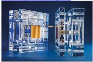
Die Testzelle aus transparentem Kunststoff ist prinzipiell funktionsfähig und wird seit Jahren erfolgreich in Forschungsprojekten eingesetzt. Zu sehen sind die Stromkollektoren, die vergoldeten Flowfield - Platten und der vergoldete Anpressstempel aus Titan. © Fraunhofer ISE
