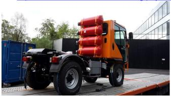
Das LADOG-Fahrzeug mit Brennstoffzelle und elektrischem Antriebsmotor in Verbindung mit zwölf 1 kWh Batteriemodulen soll innerstädtische Emissionen durch städtische Nutzfahrzeuge verringern. © Fronius International GmbH.
