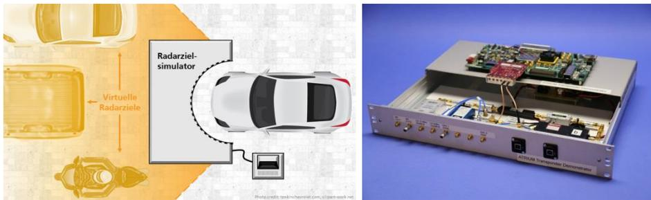
Der Radarzielsimulator ATRIUM des Fraunhofer FHR ist als Prüfstand konzipiert (links). Mit einem Demonstrator (rechts) beweist das Fraunhofer FHR aktuell das Hardware-Funktionsprinzip von ATRIUM. © Fraunhofer FHR
