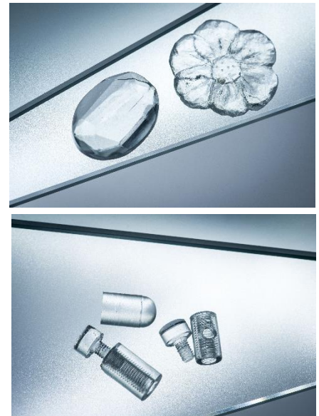
Mit Glassomer können Glaskomponenten wie diese durch Schnitzen hergestellt werden (Fotos: Markus Breig, KIT)
