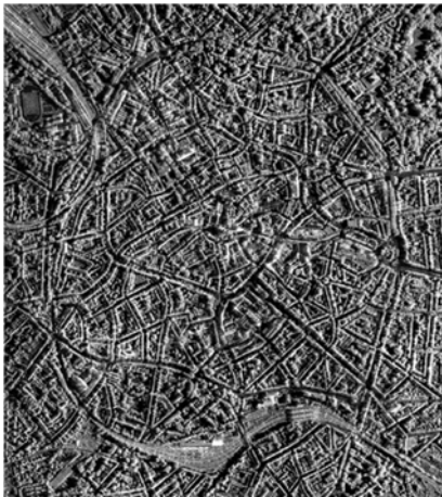
Hochaufgelöste Radarabbildung von der Innenstadt von Aachen erzeugt vom luftgetragenen Radarsystem PAMIR des Fraunhofer FHR.
