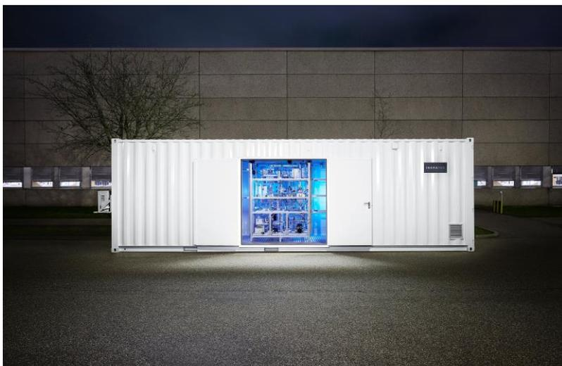
*Ineratec baut chemische Reaktoren, die so kompakt sind, dass die gesamte Anlage fertig montiert in einen Schiffscontainer passt. (Foto: INERATEC/Hauser)*
