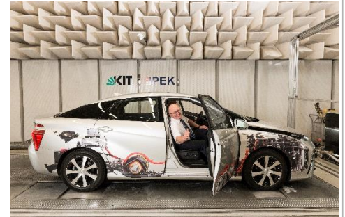
Professor Albert Albers, Leiter des IPEK, in einem Brennstoffzellenfahrzeug (Toyota Mirai) auf dem Rollenprüfstand. (Foto: Laila Tkotz, KIT).
