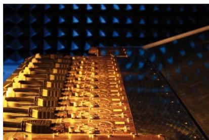
Bildunterschrift: Next Generation Schiffsradare: Das harmonische Radar SEERAD soll in Zukunft Tags in Rettungswesten detektieren und Schiffbrüchige zuverlässig orten (links). Elektronisch gesteuerte Gruppenantennen vom Fraunhofer FHR sorgen für eine verbesserte Detektionsgenauigkeit künftiger Schiffsnavigationsradare (rechts). © Fraunhofer FHR
