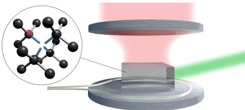
Schema der Laserschwellen-Magnetometrie. Kleines Bild: Darstellung eines NV-Zentrums im Diamant. © Fraunhofer IAF
