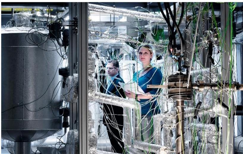
Versuchsanlage für Flüssigmetalle am KIT. Flüssige Metalle eignen sich gut zur Übertragung hoher Wärmeleistungen und im Rahmen von NADINE soll ihr Einsatz in thermischen Energiespeichern erforscht werden. (Foto: Karsten Litfin/KIT)
