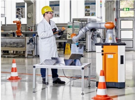
*Durchführung einer robotergestützten Prüfung von Stahlplatten. Untersucht werden mechanische Eigenschaften (u. a. Eigenspannungen) mittels mikromagnetischer Verfahren (3MA). © Fraunhofer IZFP / Uwe Bellhäuser Bild in Druckqualität unter: [www.izfp.fraunhofer.de/de/Presse/pressefotos.html](http://www.izfp.fraunhofer.de/de/Presse/pressefotos.html)*
