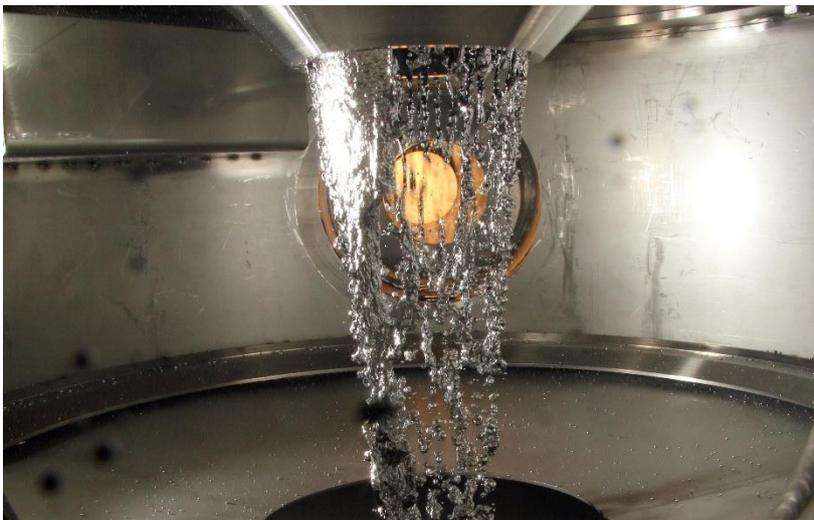
In den Versuchsanlagen des Karlsruhe Liquid metal Laboratory (KALLA) wird die Thermofluidynamik von Metallschmelzen erforscht. (Foto: Karsten Litfin, KIT)
