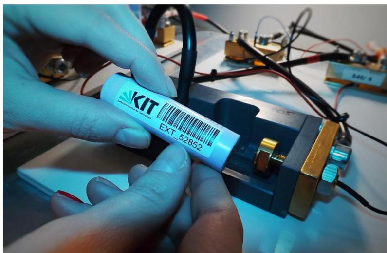
*Das Schnellladesystem setzt auf besonders langlebige Lithium-Ionen-Zellen und einen vergleichsweise starken Ladestrom von bis zu zehn Ampere. (Foto: Lea de Biasi/ Steffen Jokisch, KIT)*
