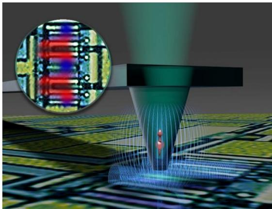
Schematische Darstellung eines Rastersonden-Quantenmagnetometers mit einer NV-Diamantspitze, die Ströme einer nanoelektronischen Schaltung bildgebend nachweist.
