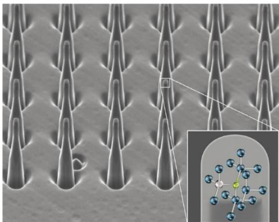
Strukturierte einkristalline Diamantspitzen. Grafik: Atomare Struktur eines NV-Zentrums in Diamant.
