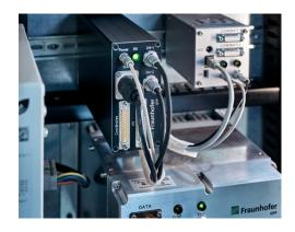
inspECT-PRO: Breitband-Mehrkanal-, Mehrfrequenz-Wirbelstromprüfelektronik zur Integration mittels Hutschienenmontage: Prüfung auch von schwach leitfähigen Materialien wie kohlestofffaserverstärktem Kunststoff (CFK)
