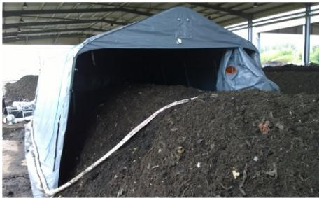
Emissionsmessung an einer Dreiecksmiete zur Nachkompostierung von Gärresten einer Bioabfallvergärungsanlage
