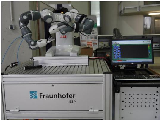
*Robotergestütztes Sensorsystem zur zerstörungsfreien Prüfung von Hybridguss-Bauteilen, welches sich ohne großen Aufwand zur Qualitätsüberwachung in Produktionsprozesse integrieren lässt.
