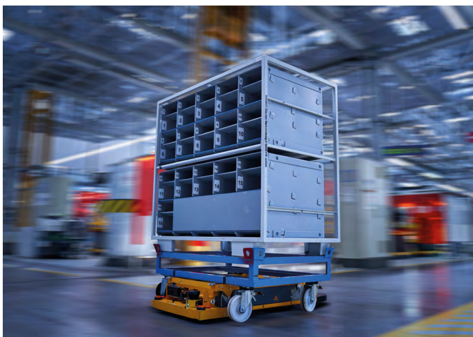
Der Smart Transport Robot (STR) bei BMW navigiert mithilfe der IPA-Software autonom durch die Produktionshallen.
