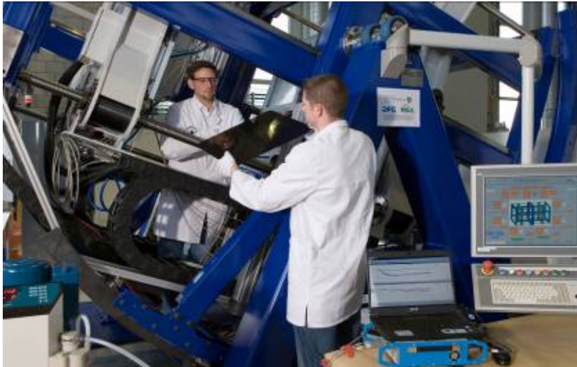
Schritt in die FVK-Großserie: Spaltimpregnieranlage am IKV (Bild: Winandy/IKV)
