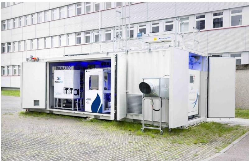
Weltweit erste integrierte Power-to-Liquid (PtL) Versuchsanlage zur Synthese von Kraftstoffen aus dem Kohlendioxid der Luft. (Foto: Projekt P2X)
