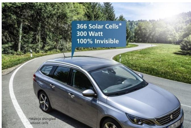
Photovoltaik unsichtbar in ein Autodach integriert: Die Morpho-Color®-Glasbeschichtung ermöglicht eine Anpassung der Farbe an das Fahrzeug. © Fraunhofer ISE
