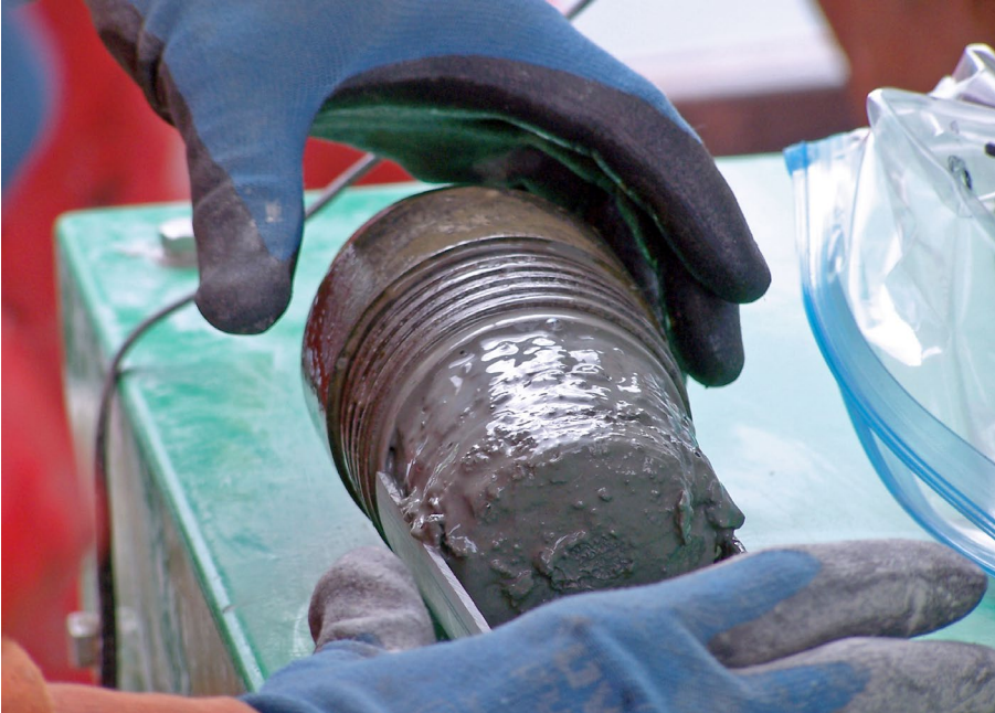
LIAG/T. Grelle: Vorbereitungen an einem Bohrkern, den die Forscherinnen und Forscher aus dem maximal 293 Meter tiefen See geborgen haben.
