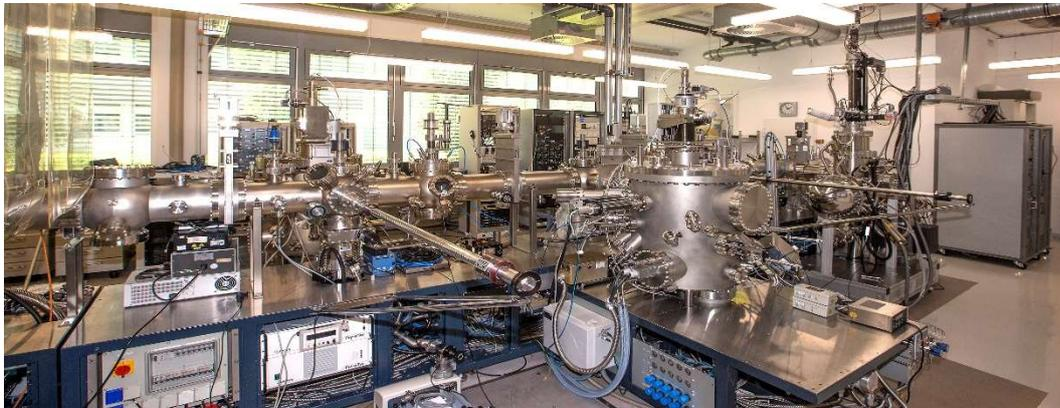
Blick in das Molekularstrahlepitaxie-Labor des IHP. Die Molekularstrahlepitaxie (englisch molecular beam epitaxy, MBE) ist ein Verfahren der physikalischen Gasphasenabscheidung, um kristalline dünne Schichten (bzw. Schichtsysteme) herzustellen. Es findet zum Beispiel Anwendung in der Nanotechnologie. © IHP/Mausolf 2019
