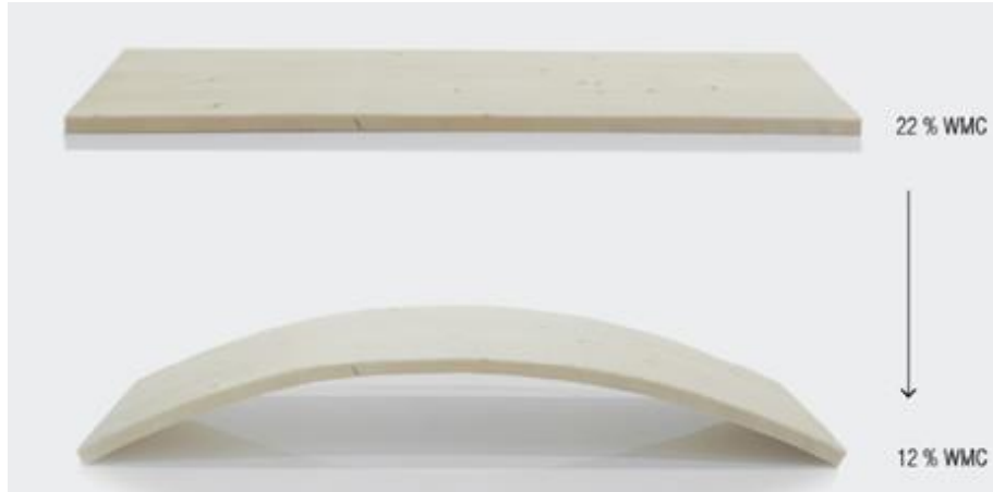
Eine zweischichtige Bilayer-Holzplatte krümmt sich während der Trocknung (WMC: Feuchtigkeitsgehalt des Holzes). Foto: Universität Stuttgart, ICD/ITKE
