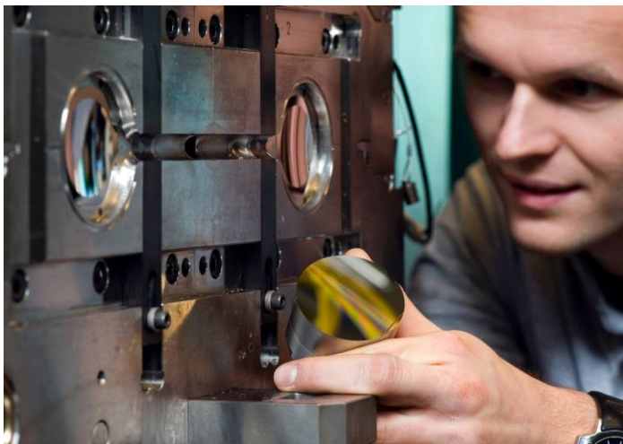
Werkzeug für optische Formteile im Spritzgießtechnikum des IKV (Bild: Winandy/IKV)
