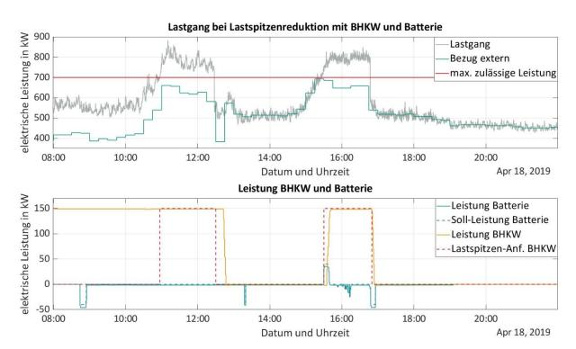
Messreihe einer am Fraunhofer IISB durchgeführten Lastspitzenreduktion: Bei einer Vorgabe von einer maximal zulässigen Bezugsleistung von 700 kW konnten die Lastspitzen von 870 kW um ca. 20 % auf 695 kW reduziert werden. Bild: Fraunhofer IISB
