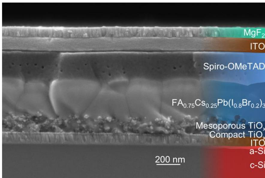
Struktur einer Tandemzelle mit einer nur wenige 100 Nanometer dünnen Perowskit-Schicht, wie sie aktuell realisiert wird. Problematisch ist die Verwendung von Blei. © Fraunhofer ISE
