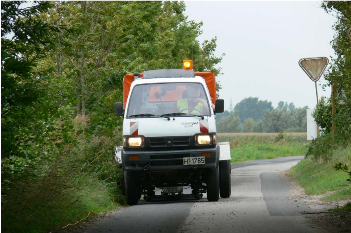
Foto 2: Vorerkundung für die Bohrung: Seismikmessfahrzeug des LIAG (P-Wellen Vibrator), Frontalansicht mit ausgefahrender Vibratorplatte unter dem Fahrzeug.
