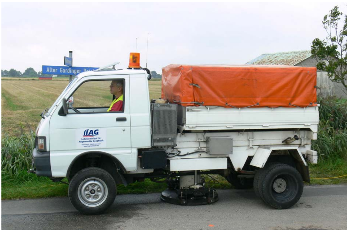
Foto 1: Vorerkundung für die Bohrung: Seismikmessfahrzeug (P-Wellen Vibrator), die Vibratorplatte ist ausgefahren und an den Boden gepresst. Sie sendet seismische Signale in den Untergrund.
