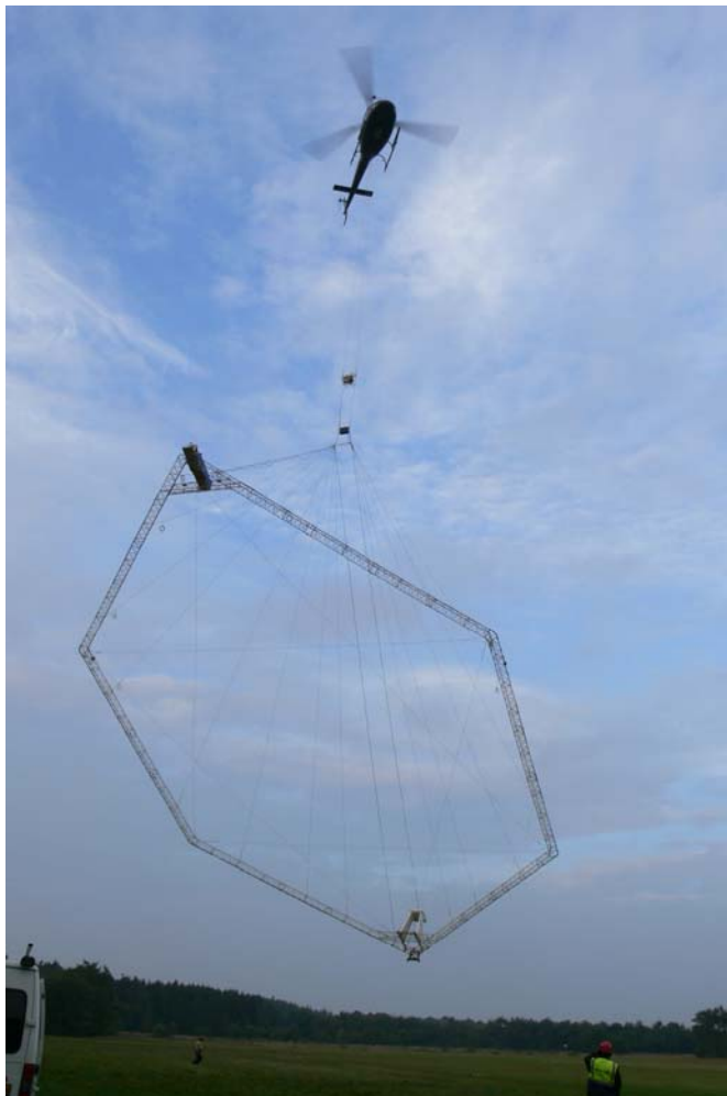
Foto 4, oben: Ein fliegendes Messsystem SkyTEM, sendet elektromagnetische Signale aus, deren „Echos“ Auskunft über den Aufbau des Untergrundes geben. TEM ist die Abkürzung für Transienten-Elektromagnetik.
