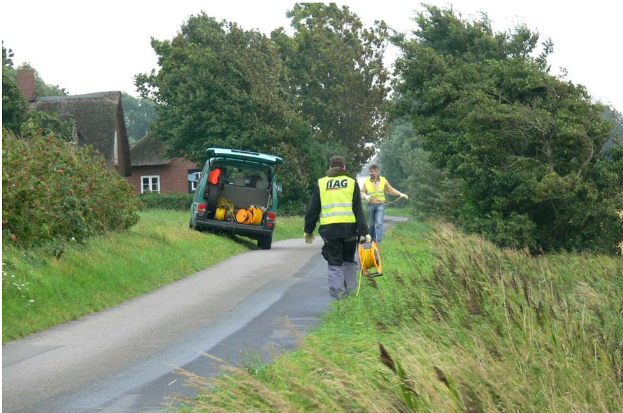
Foto 3: Einige tausend Meter Messkabel verbinden die Zahlreichen Geophone, die in die Erde gesteckt wurden.
