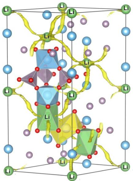
Hoffnungsträger für noch leistungsfähigere Lithium-Ionen-Batterien: Festkörper-Elektrolyt (hier  $\text{LiTi}_2(\text{PO}_4)_3$ , Li-grün, Ti-blau, P-lila, O-rot) mit Darstellung der »Wanderungspfade« für Lithium-Ionen (gelbe Bänder).
