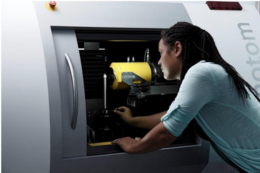
*Vom Nano-Bereich zur Analyse von Partikelverteilungen bis zur Strahlung auf ganze Erdblöcke für archäologische Zwecke: Am fem in Schwäbisch-Gmünd werden mit 3D-Röntgen-Computertomographie verschiedenste Stoffe durchleuchtet. Bildquelle: fem*
