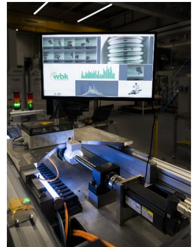
Prüfstand für die Untersuchung von Laufbahnschäden am Kugelgewindetrieb (Foto: Markus Breig, KIT)
