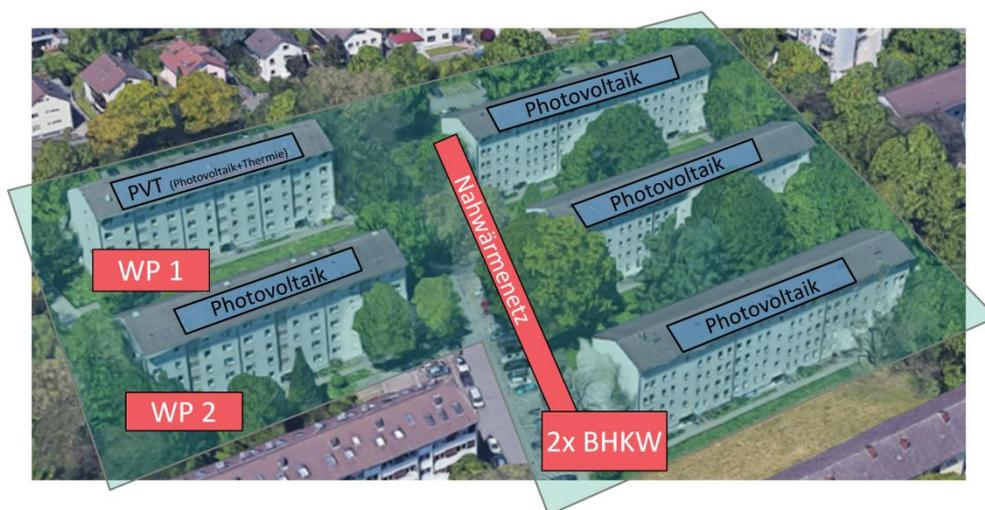
Energieversorgungskonzept des »Smarten Quartiers Karlsruhe-Durlach« mit Photovoltaik, zwei dezentralen Wärmepumpen (WP) und zwei Blockheizkraftwerken (BHKW) mit Nahwärmeleitung.
