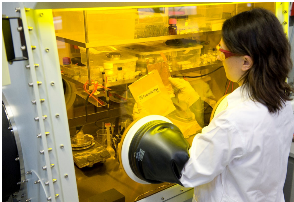
Herstellen von Testzellen mit neuen Batteriematerialien © K. Dobberke, Fraunhofer ISC
