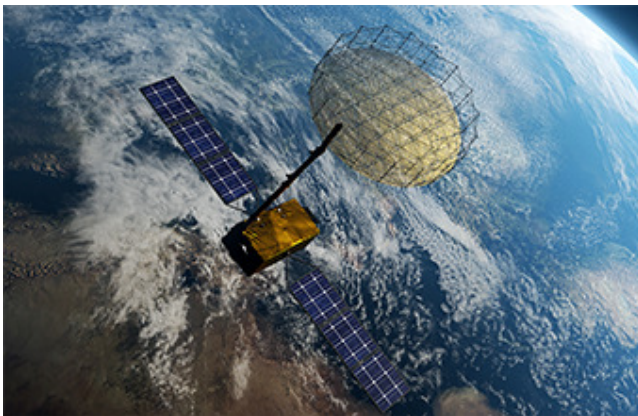
Abb. 1: Reflektorantenne LEA-X5 auf einem Satelliten (Visualisierung: HPS GmbH/WeLEA)
