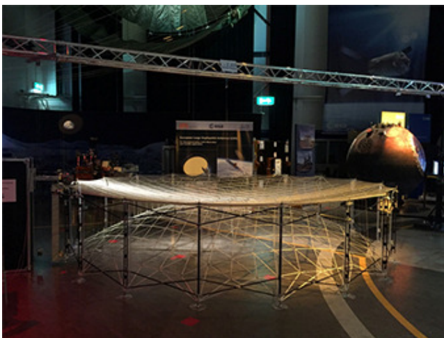
Abb. 2: Reflektorantenne als 5m Ingenieursmodell (Foto: ESA, HPS GmbH, LSS GmbH)
