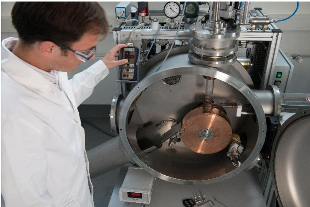
Meltspinner im Technikum des Fraunhofer IWKS. © Fraunhofer IWKS
