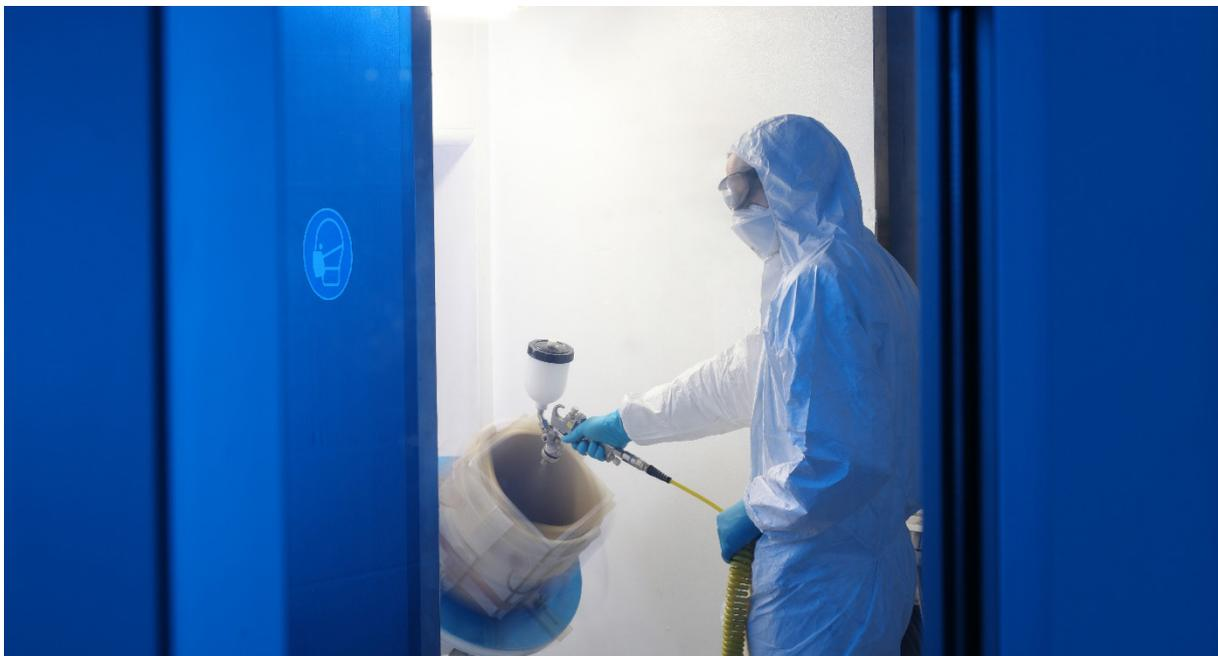
*Herstellung einer Sprühbeschichtung auf einem G1-Tiegel am Fraunhofer IISB im Rahmen des SYNERGIE Projektes. Bild: Kurt Fuchs / Fraunhofer IISB*
