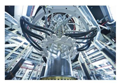
So wird die Folie aus Biokunststoff produziert: Der Extruder erzeugt die als transparente Säule sichtbare Blase. Am oberen Ende der Säule wird die Folie zusammengelegt. Bildquelle: Südpack
